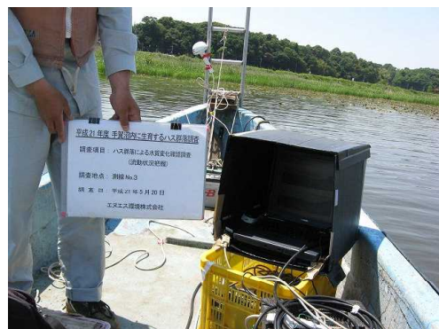
ADCP による流動状況観測状況
