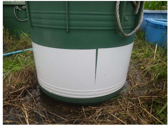
遮熱シート設置状況 (令和2年6月18日, 手賀沼親水広場)
